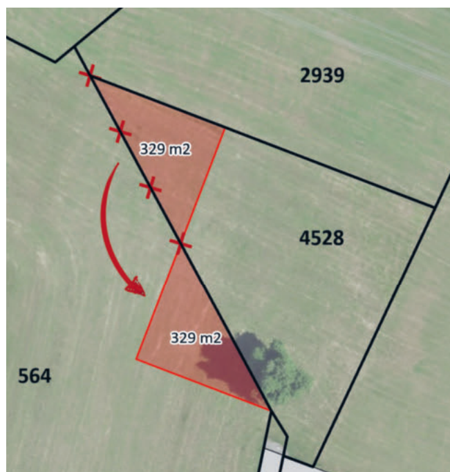
Das obere rote Dreieck wird dem Grundstück GS Nr. 564 zugeschlagen. Im Gegenzug wird das untere rote Dreieck vom GS Nr. 564 zum GS Nr. 4528 verschoben.
