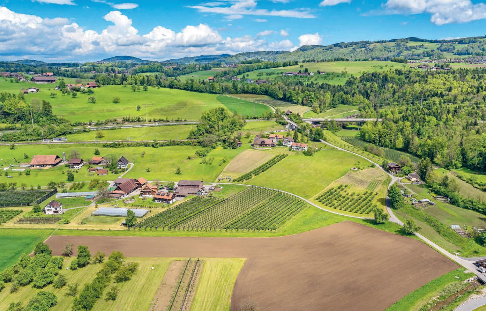
Hier im Gebiet Deinikon und Bofeld wird das Portal des Zimmerbergtunnels II entstehen. Mit dem Ausbruchmaterial soll – so die Absicht der SBB – das Gelände modelliert und die Autobahn zum Teil überdeckt werden. (Bild: Andreas Busslinger)
